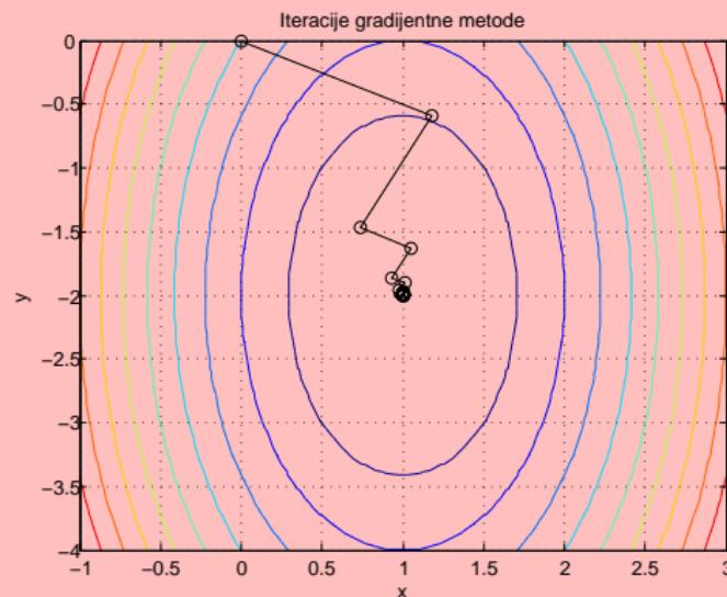
**Slika:** Iteracije gradijentne metode za funkciju
